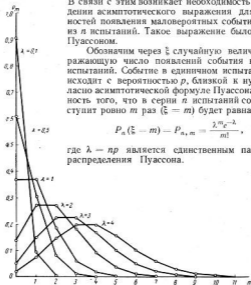
Рис. 9. Распределения Пуассона при различных значениях \lambda .
