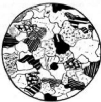
Рис. 47. Гранобластовая структура мелко-зернистого биотит-плагиоклазового гнейса ( $d=2$  мм, с включенным анализатором, по Ю.И. Полоцкимой)
